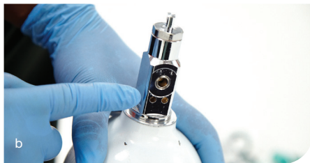
Figure 4-3, a-d : Pour fixer un régulateur de pression autonome à une bouteille d'oxygène : a, insérez le joint dans le régulateur de pression; b, vérifiez que la configuration des broches correspond à la bouteille d'oxygène; c, insérez les broches du régulateur dans la bouteille et serrez la vis manuellement jusqu'à ce que le régulateur soit bien ajusté; et d, ouvrez la valve de la bouteille et vérifiez la pression présente dans la bouteille.
