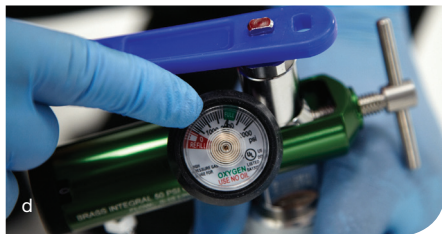
Figure 4-3, a-d : Pour fixer un régulateur de pression autonome à une bouteille d'oxygène : a, insérez le joint dans le régulateur de pression; b, vérifiez que la configuration des broches correspond à la bouteille d'oxygène; c, insérez les broches du régulateur dans la bouteille et serrez la vis manuellement jusqu'à ce que le régulateur soit bien ajusté; et d, ouvrez la valve de la bouteille et vérifiez la pression présente dans la bouteille.
