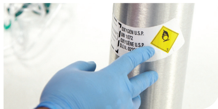
Figure 4-2 : Une bouteille d'oxygène présente généralement une partie supérieure verte ou blanche ainsi qu'un losange jaune, qui indique qu'elle contient de l'oxygène.
